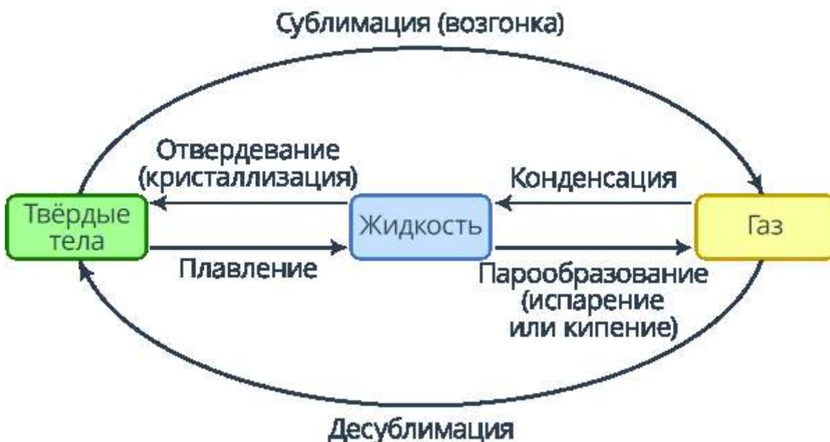
Рис. 1. Схема изменения агрегатного состояния вещества
